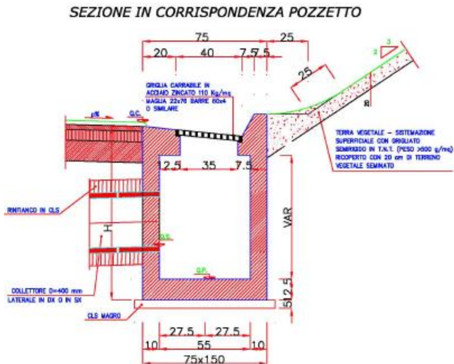
Figura 5 - Smaltimento acque nei tratti in trincea
