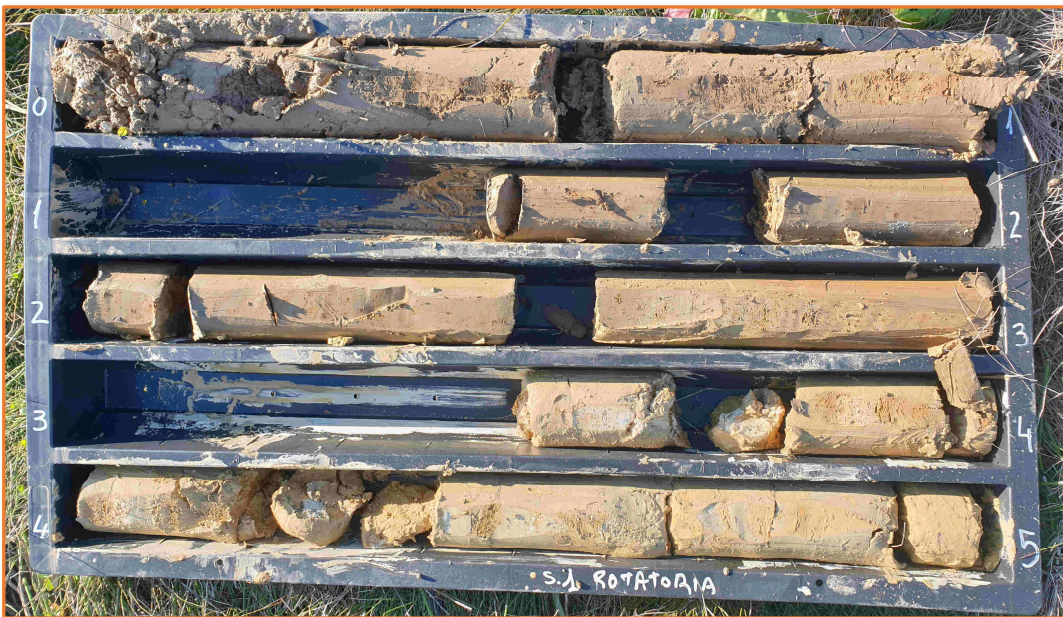
Cassetta catalogatrice sondaggio S1 da 0,0 a -5,0 mt
