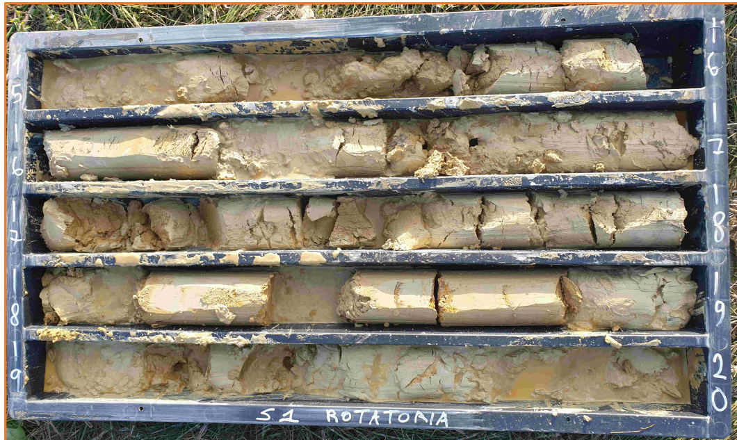
Cassetta catalogatrice sondaggio S1 da -15,0 a -20,0 mt
